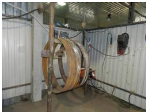
Рисунок 1 – Испытательный образец трубопровода, используемый в экспериментах
